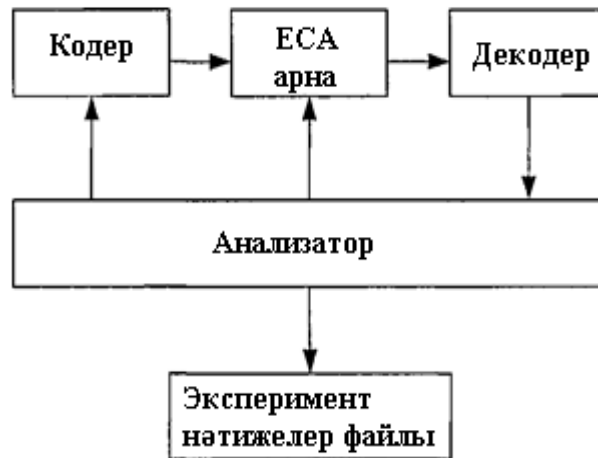
3 Сурет – ЕСА арнасындағы ЖК кодын декодтауға арналған бағдарламалық үлгінің құрылымы
